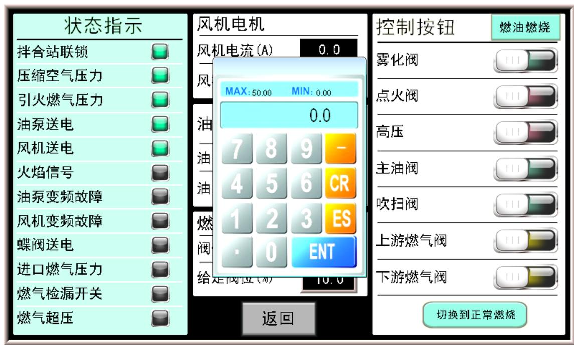
图 22 风机和油泵运行调试
