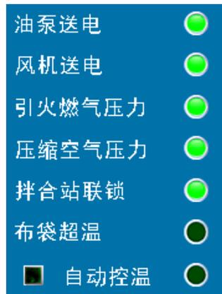
图 26 燃烧主控制界面左侧指示灯
