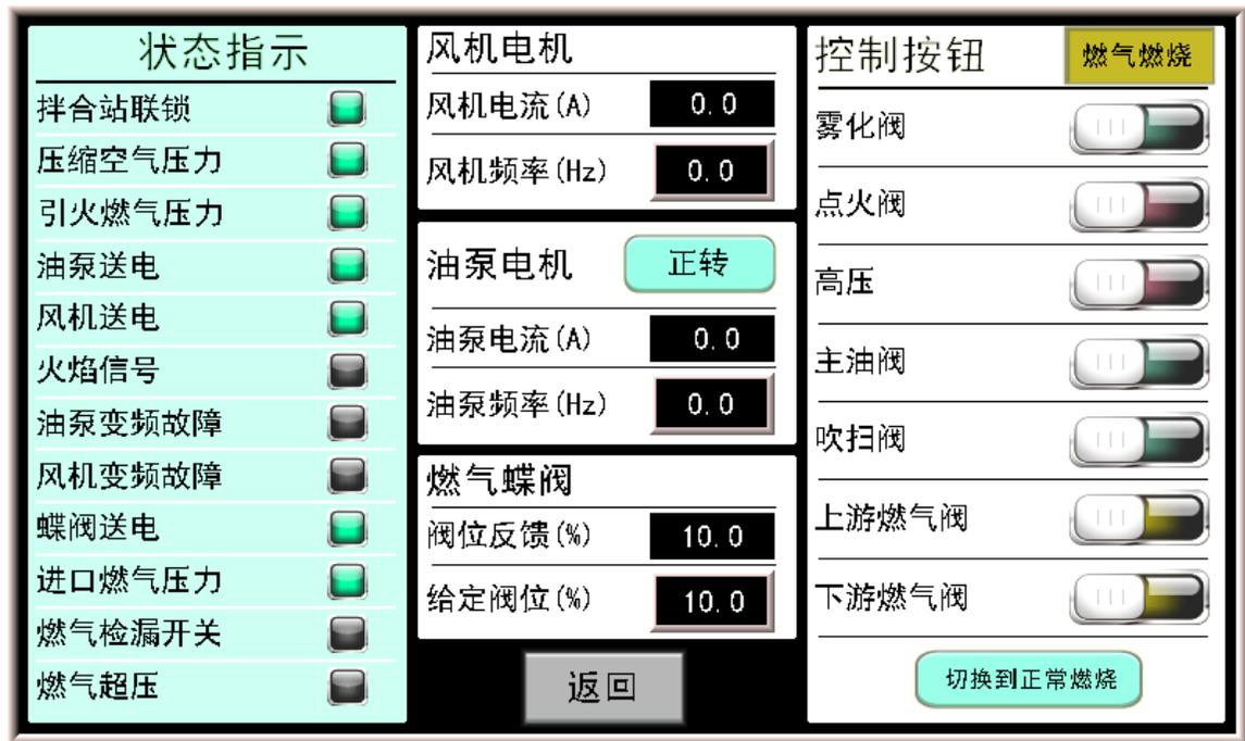
图 21 燃气模式手动调试界面
