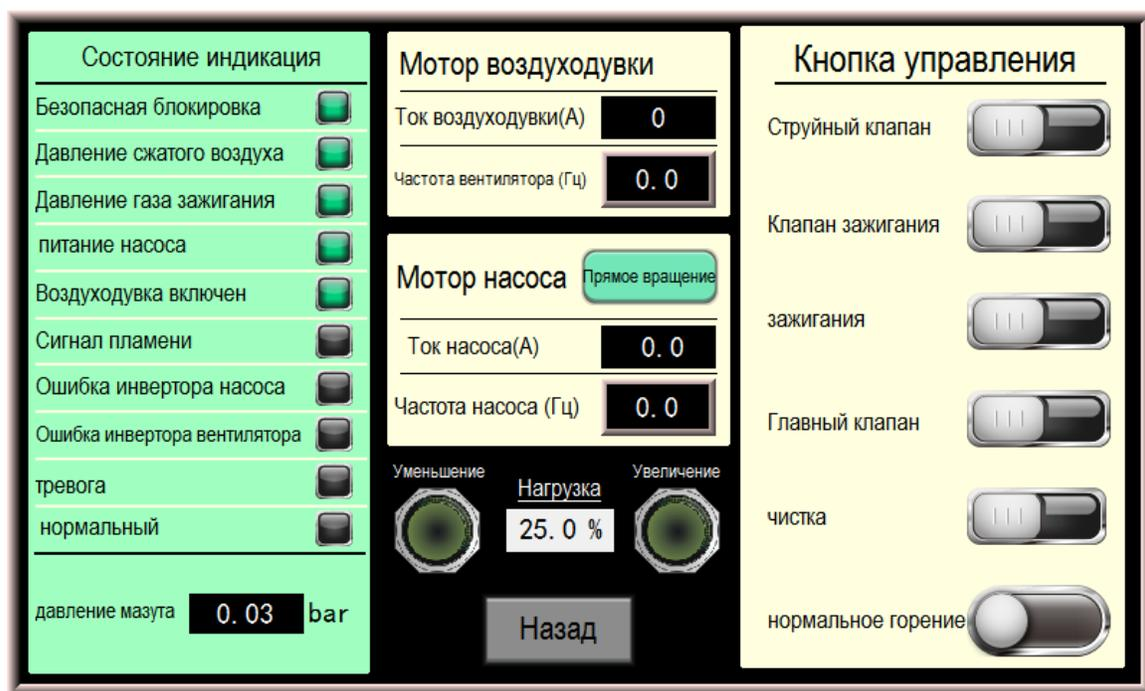
Рис. 16. Интерфейс ручной настройки
