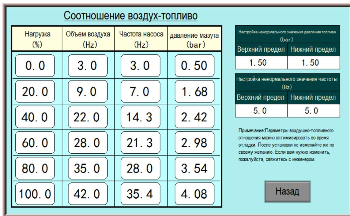
**Рис. 20. Интерфейс настройки воздушно-топливного соотношения**
