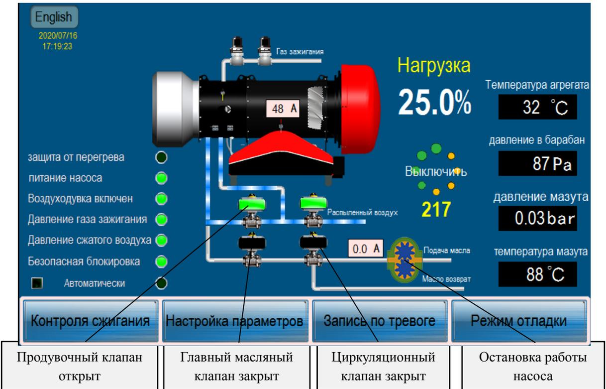
Рис. 30. Система переходит в состояние гашения огня 3
