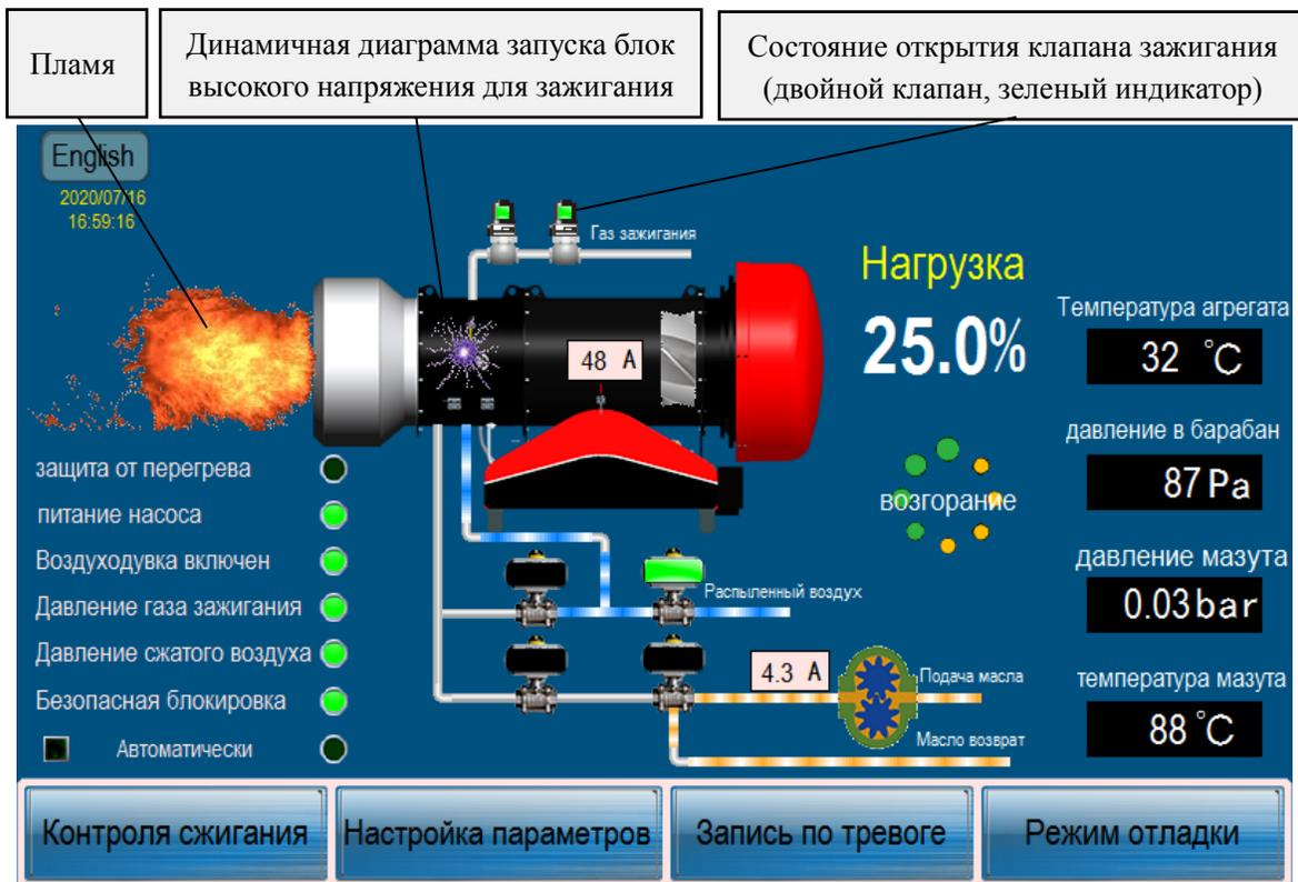
Рис. 24. Интерфейс системы на этапе газового зажигания
