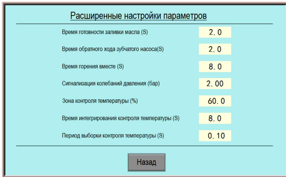
**Рис.19. Интерфейс настройки расширенных параметров**
