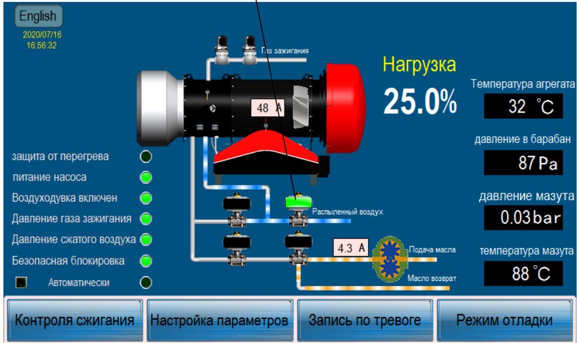
Рис. 23. Интерфейс системы на этапе открытия распылительного клапана перед зажиганием
