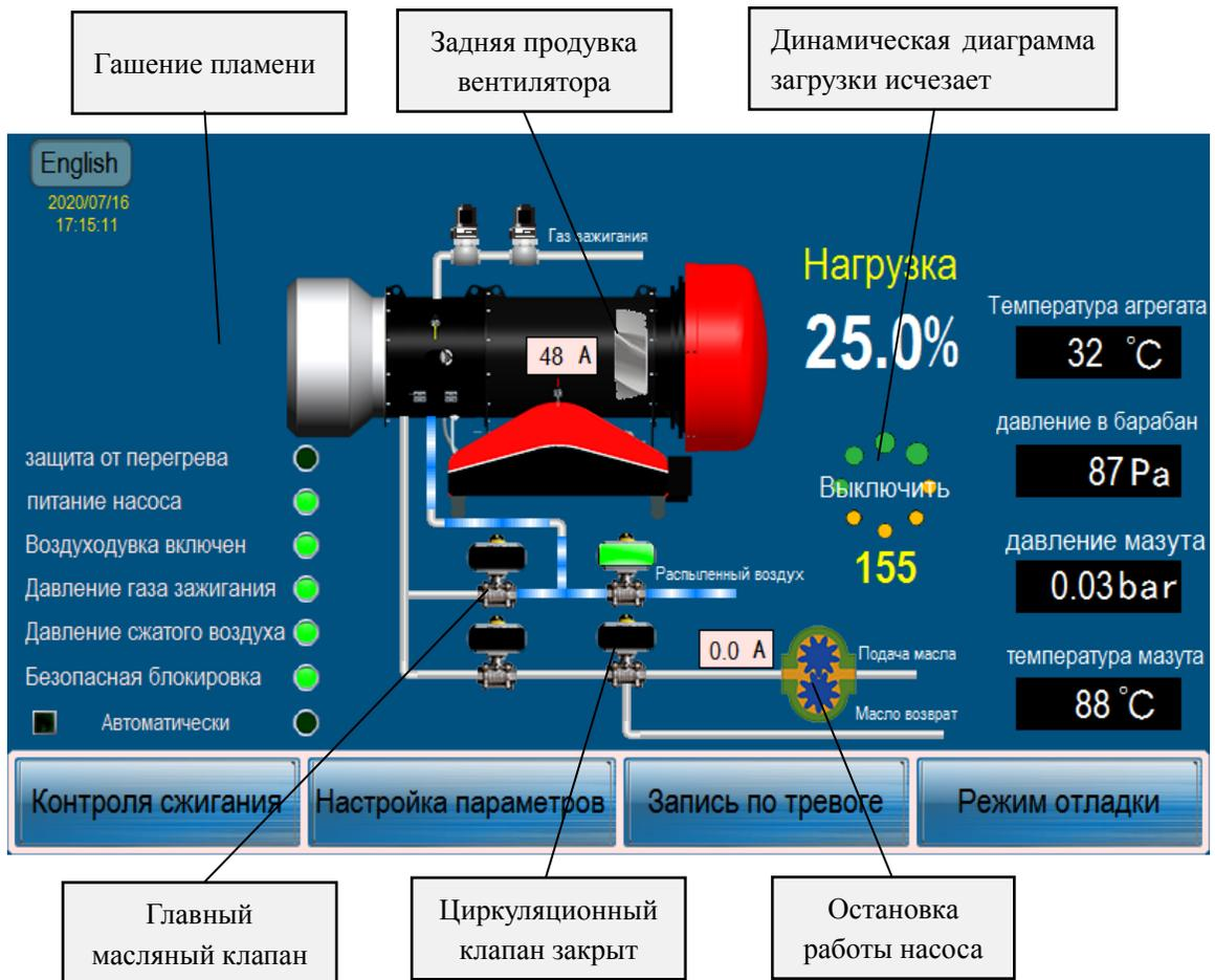
Рис. 28. Система переходит в состояние гашения огня 1
