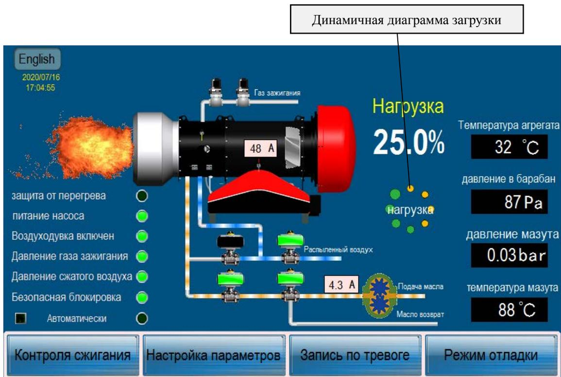
**Рис. 27. Система переходит в нормальное состояние загрузки сжигания**
