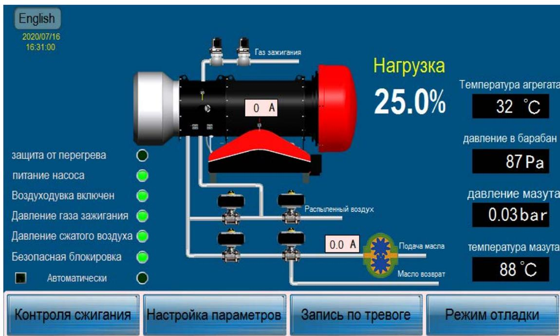
**Рис. 13. Главный интерфейс горелки**
