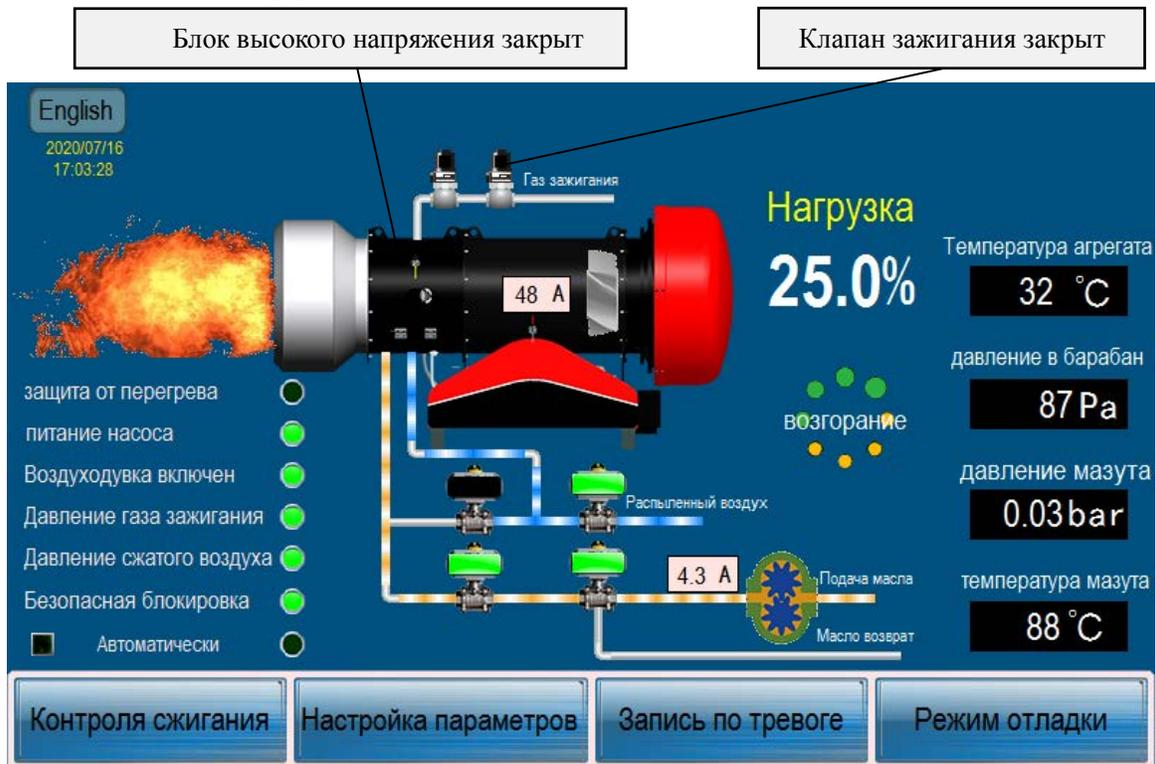
Рис. 26. Интерфейс состояния зажигания топлива в системе
